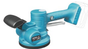
DED6912 rezgésfrekvencia 0-7500min-1, tapadókorong átmérője: 130mm, max. terhelés: 50kg, 5 fokozatú rezgésintenzitás-szabályozás, 30-1200mm-es csempekhez alkalmas, 2 funkció: tapadókorong lehetővé teszi a csempek kezelését; a rezgések a csempe alatt a ragasztót a beépítés során szétterítik és eltávolítják a légbuborékokat.
