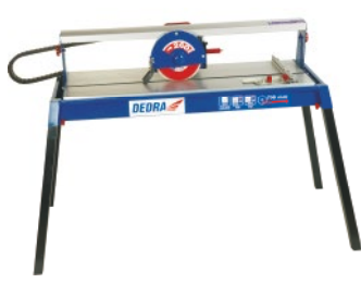
DED7828 Tárcsa 200/25,4 mm, munkaasztal mérete 990x394 mm, max. 45°-os vágási szög, vágóhossz max.650mm
